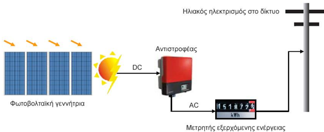
Εικόνα 3: Σχηματική διάταξη λειτουργίας φωτοβολταϊκού συστήματος
