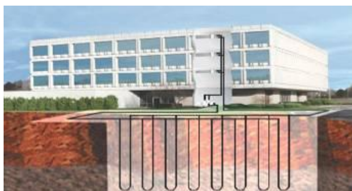
Εικόνα 10: Εφαρμογή γεωθερμικού κλιματισμού σε κτήριο γραφείων 11
